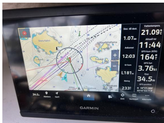
På bilden kan man se att man följer en Laylines (grön linje). Man kan även se en röd linje, om man följer den gröna linjen där plotter föreslår att man ska "slå". Utöver detta kan man även se linjerna som är bäring till målet samt linjen för kurs över grund.
